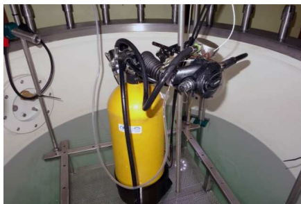
Stanowisko badawcze – symulator oddychania – sztuczne płuca
